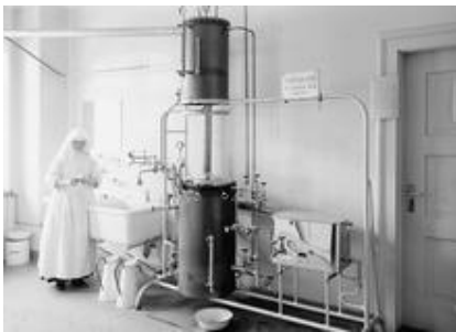
Apparatus to sterilize surgical instruments, Verwaltungsgebäude der Schweiz. Kranken- und Hilfsanstalt, 1914-1918
